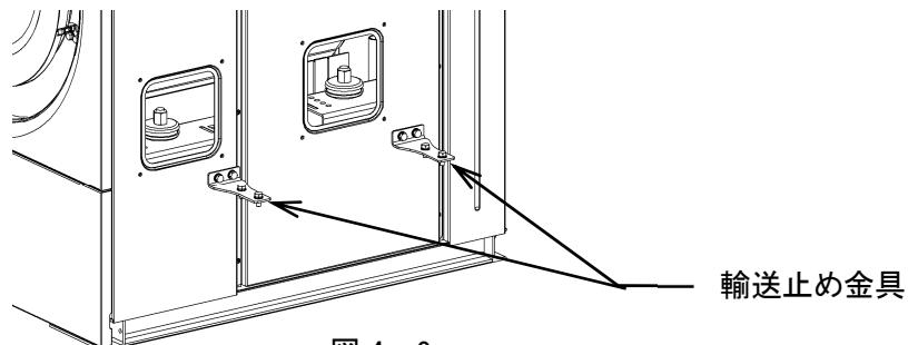
2) 輸送止め金具を取り外した後は必ず付属の輸送止め用カバー左右計 4ヶ所を取り付けてください。
