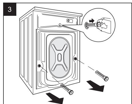
輸送用ボルトを外した後、固定ピンを全て取外してください。
