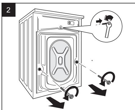
本体を起こし、必ずドラムを固定している輸送用ボルト3点を、付属しているスパナで取外してください。
